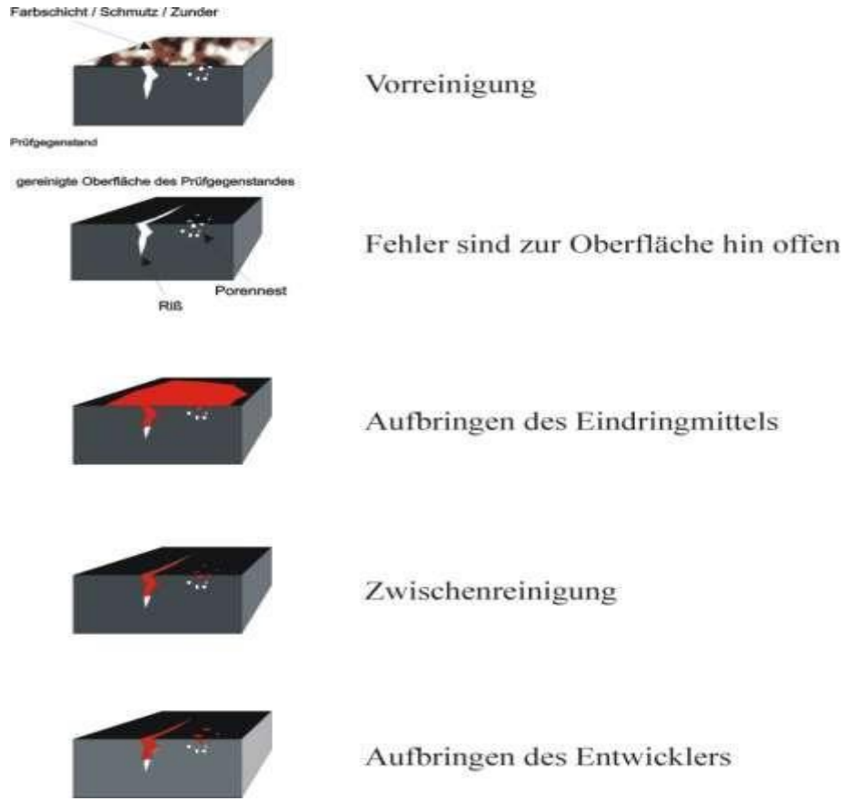
Şekil 22. Penetrant işlemi adımları
