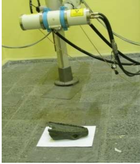
Şekil 17. Bir arkeolojik objenin X-ışını ile radyografik kontrolü
